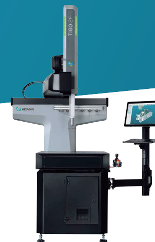
TIGO SF/7.10.7 SF/4.5.4 SF 车间现场的尺寸测量与控制
